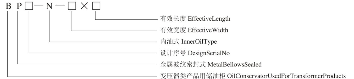
示例: 1、设计序号为1, 有效宽度920mm, 有效长度为3300的内油式金属波纹储油柜产品所对应的型号为: BP1-N-920×3300
